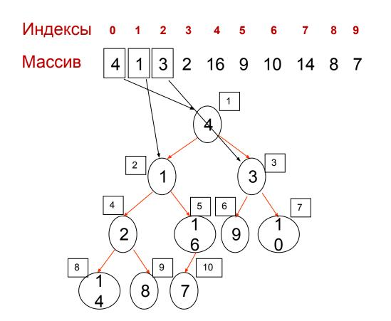
Получилось бинарное дерево общего вида, ключи узлов которого являются соответствующими элементами сортируемого массива
