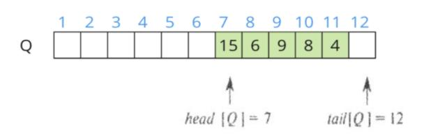
считаем, что блок памяти цикличен и при достижении края переходим вначало выделенных адресов
