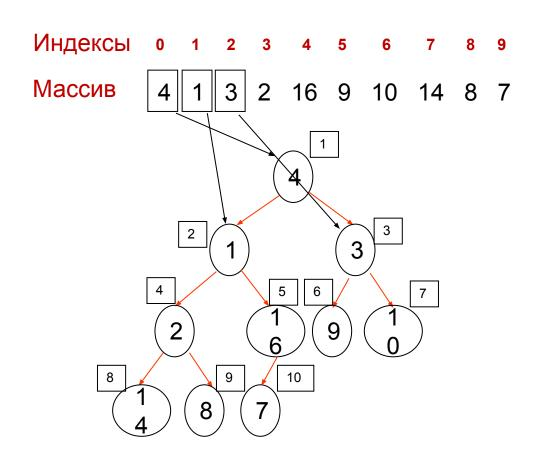
Получилось бинарное дерево общего вида, ключи узлов которого являются соответствующими элементами сортируемого массива
