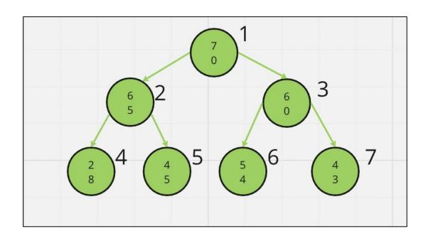
Для сортировки в порядке *убывания* используется другой вариант пирамидального дерева, в котором ключ корня любого поддерева *не больше*, чем ключи двух его дочерних вершин
