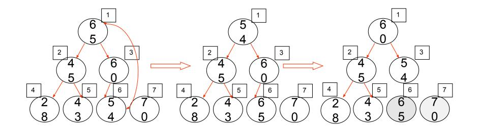
Можно сказать, что произошёл выбор наибольшего элемента в неупорядоченной части массива, который теперь можно присоединить к уже упорядоченной части, поменяв местами с *предпоследним* элементом
