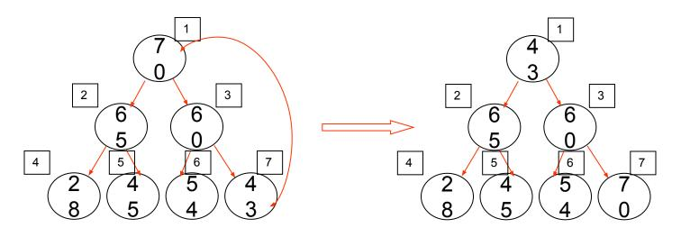
По основному свойству пирамиды максимальный элемент (70) находится в её корне и имеет индекс 1. При сортировке в порядке возрастания максимальный элемент должен находиться в конце массива, быть последним, поэтому узел с индексом 1 можно поменять местами с последним узлом (43), имеющим индекс 7, после чего исключить его из дальнейшей сортировки
